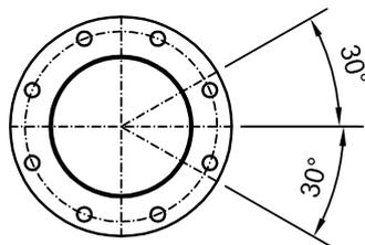
(Abbildung mit Glattflansch ähnlich DIN 2576)
